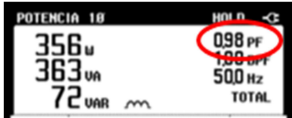
Figura 27. Factor de potencia corregido en la entrada del prototipo.
