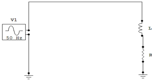
Fig. 6. Circuito con carga tipo R-L
